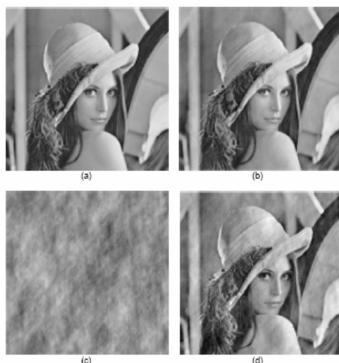
Fig. 2.3: Marcajul inserat în amplitudinea coeficienților Fourier (a) Imaginea originală, (b) Imaginea marcată, (c) Diferența W(x, y) = I - I_w , scalată pentru a fi vizibilă, (d) Imagine puternic marcată
