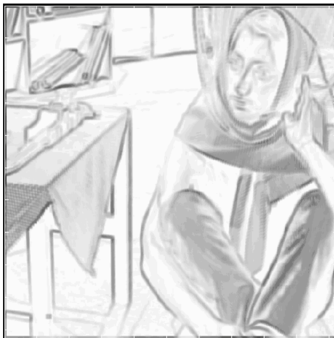
Fig. 5.8(a): Deviația standard locală a imaginii Barbara. Imaginea este complementara imaginii reale.
